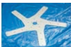
STERN MIT 5 SPEICHEN ZUR BEFESTIGUNG DER FLÜGEL
