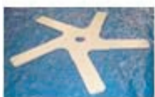
STERN MIT 5 SPEICHEN ZUR BEFESTIGUNG DER FLÜGEL
